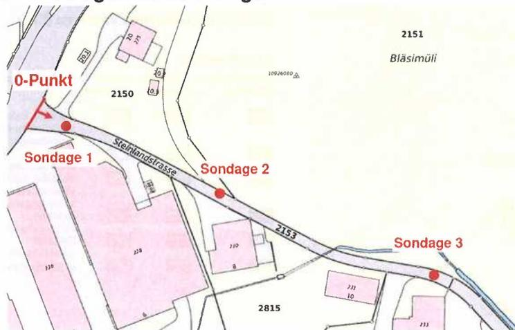
Abbildung 4: Sondagen Strassenkörper
